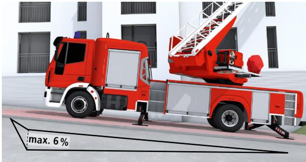
Les surfaces d'appui doivent être suffisamment résistantes pour supporter le passage de véhicules sapeurs-pompiers d'une masse totale de 18 t et d'une charge par essieu maximale de 10 t.
